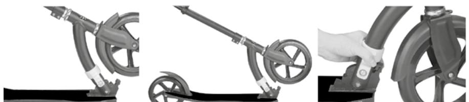
Pakelkite paspirtuko išleidimo mechanizmo lanką į viršų. Po to kelkite vairo koloną į vertikalią poziciją kol išgirsite trakštelėjimą, kuris signalizuoją, kad vairas teisingoje pozicijoje. Išleidimo mechanizmas automatiškai užsiblokuos.
