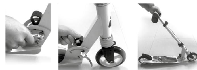
Odblokuj blokadę mechanizmu służącego do składania produktu poprzez podniesienie dźwigni, po czym podnieś plastikowy element mechanizmu składania pojazdu ku górze, aby zwolnić blokadę składania. Podnieś kolumnę kierownicy do pionu aż usłyszysz kliknięcie sygnalizujące, że kierownica jest we właściwej pozycji. Zaciśnij blokadę mechanizmu składania. Jeśli po zablokowaniu kolumny kierownicy nadal możliwy jest jej ruch, należy dokręcić nakrętkę po przeciwnej stronie niż dźwignia.
