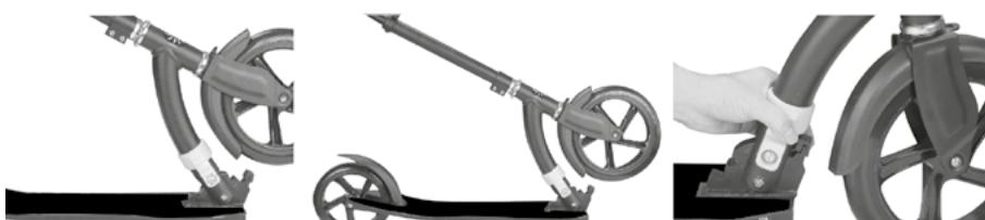
Zdvihnite plastovú obrúčku mechanizmu skladania vozidla nahor. Následne zdvihnite stĺpik riadičiel, až dosiahne vertikálnu polohu a budete počuť kliknutie, ktoré signalizuje jeho správnu polohu. Mechanizmus skladania sa automaticky zablokuje.
