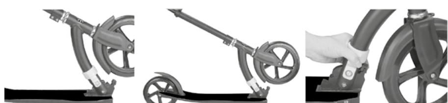
Podnieś plastikową obręcz mechanizmu składania pojazdu ku górze. Następnie podnieś kolumnę kierownicy, aż osiągnie pozycję pionową i usłyszysz kliknięcie sygnalizujące jej poprawne położenie. Mechanizm składania automatycznie się zablokuje.
