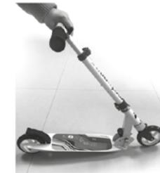
Tõstke juhtraua toru püstiasendisse, kuni kostub klöpsatus, mis kinnitab õigesse asendisse paigaldamist. Pigistage kokkupaneku mehhaniini kinni. Kui pärast juhtraua toru lukustamist see siiski liigub, tuleb kinnitada hoova vastasküljel paiknevat kruvi.
