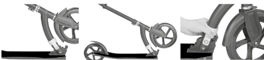
Zvedněte plastovou obroučku mechanismu skládání vozidla nahoru. Následně zvedněte sloupek řídítka, až dosáhne vertikální polohy a uslyšíte kliknutí, které signalizuje jeho správnou polohu. Mechanismus skládání se automaticky zablokuje.
