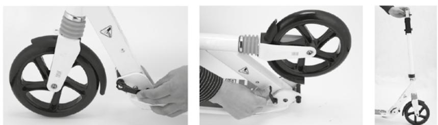
zvuk neozve, znamená to, že je nezbytná regulace mechanismu. Použijte k tomu imbusový klíč velikosti 2 a uvolněte šroubky tak, jako na obrázku. Zamáčkněte aretaci skládacího mechanismu. Pokud je po zablokování sloupu řídítka nadále možné, aby se pohyboval, dotáhněte matici na opačné straně, než se nachází páka.
