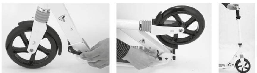
Pokiaľ sa tento zvuk neozve, znamená to, že je nevyhnutná regulácia mechanizmu. Použite na to imbusový kľúč veľkosti 2 a uvoľnite skrutky tak, ako na obrázku. Zatlačte aretáciu skladacieho mechanizmu. Pokiaľ je po zablokovaní stĺpika riadičiel nadalej možné, aby sa pohyboval, dotiahnite maticu na opačnej strane, než sa nachádza páka.
