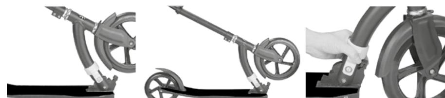
Tõstke toote kokkupanekuks möeldud mehhaniini plastvõru üles. Seejärel tõstke juhtraua toru püstiasendisse, kuni kostub klöpsatus, mis kinnitab õigesse asendisse paigaldamist. Kokkupaneku mehhaniini lukustub automaatselt.
